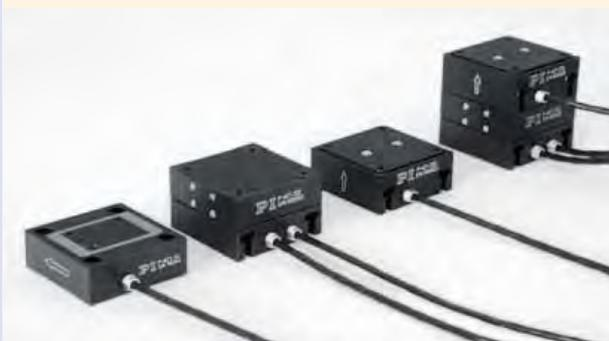
Die neue PIHera<sup>TM</sup> Piezo-NanoPositioniertisch-Familie: P-621.1CL, X-Tisch, P-621.2CL, XY-Tisch, P-621.ZCL, Z-Tisch und XYZ Kombination (v. l. n. r.). PIHera<sup>TM</sup> Tische sind mit 50, 100, 250 und 500  $\mu\text{m}$  Hub verfügbar. Geregelter und unregelter Versionen werden angeboten.
