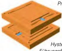
Prinzipdarstellung eines gestapelten XY Nanopositioniertisches (serielle Kinematik). Nachteile gegenüber Parallel-Kinematiken sind: Höheres Massenträgheitsmoment, höherer Schwerpunkt, bewegte Kabel (können Reibung und Hysterese verursachen). Automatische Führungsfehlerkompensation nicht möglich.
