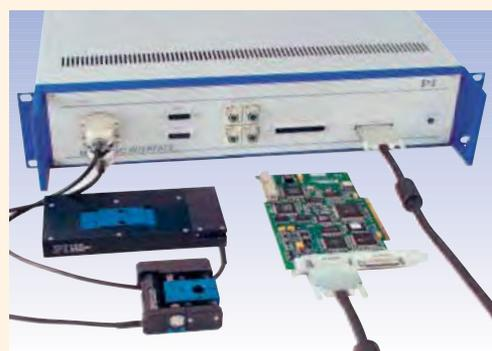
C-809.40 Servo-Verstärker mit NI-7344 Controller und einigen Mikropositioniersystemen
