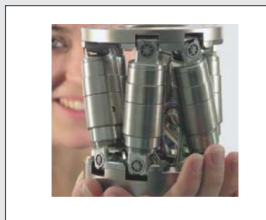
M-810, Miniature Hexapod Ø=100mm, H=118mm, max Load= 5kg, X,Y: +/-20mm, Z: +/-6.5mm, rot U,V +/-11°, rot W +/- 30°
